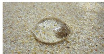
図2 疎水性をもつ豊浦砂上の水滴の様子
